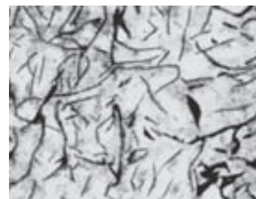
شکل ۲-۴۹ چدن خاکستری با گرافیت ورقه‌ای
