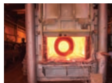
شکل ۲-۴۳ کوره عملیات حرارتی کارگاهی
