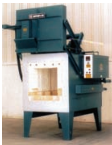
شکل ۸-۴ دیواره کوره از جنس سرامیک
