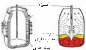
شکل ۲-۸ کوره L-D یکی از روش‌های تولید فولاد.
