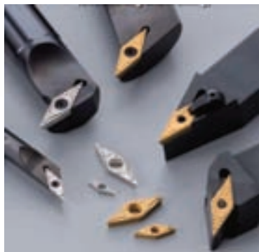
شکل ۳-۵۳ ابزارهای روکش شده با تیتانیم
