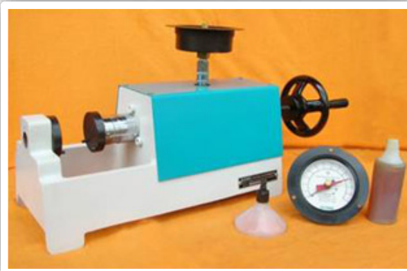
نمونه ای از دستگاه اندازه گیری استحکام فشاری تر
